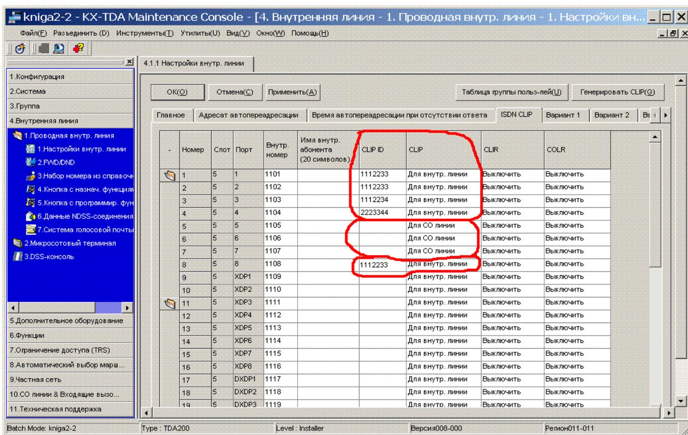
В колонке CLIP ID каждому внутреннему абоненту прописываем номер, который будет являться CLIP ID при исходящих вызовах с этого внутреннего абонента. Для ускорения процесса назначения индивидуального CLIP ID для каждого абонента можно пользоваться встроенным CLIP генератором (кнопка сверху CLIP GENERATE) – он поможет по заданному шаблону назначить CLIP ID для всех абонентов (мы не будем здесь описывать работу генератора ввиду очевидности)
