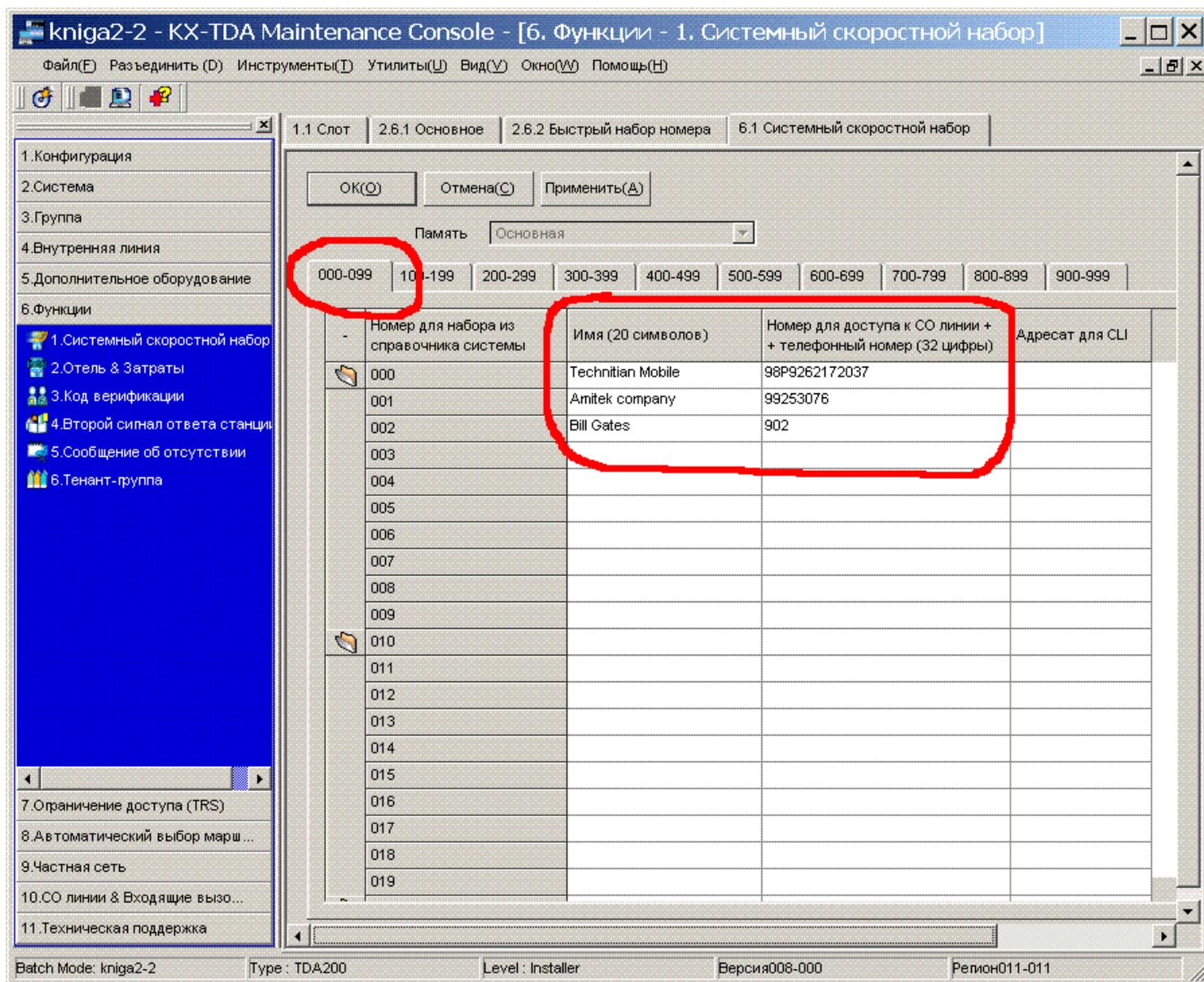
Сверху в меню выбираем блок из 100 ячеек памяти, с которыми будем работать. В каждой ячейке прописываем название и номер быстрого набора. В соответствии с нумерационным планом (команда 2.6.1) доступ к этим ячейкам быстрого набора по умолчанию - \*\* (две звездочки) и номер ячейки.
