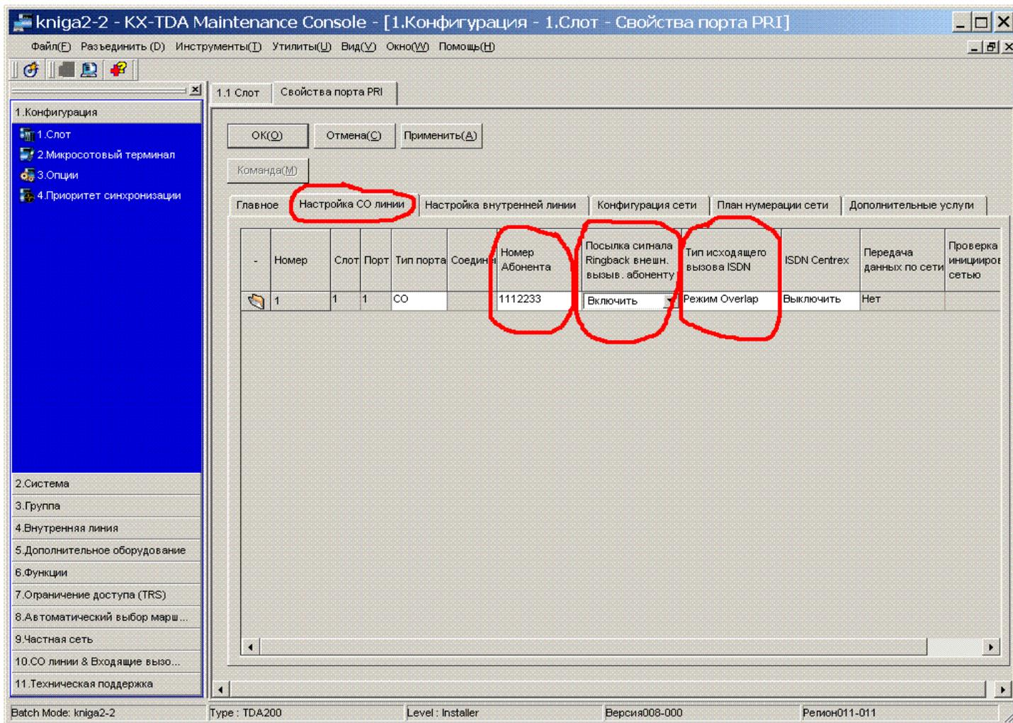
В колонке SUBSCRIBER NUMBER (НОМЕР АБОНЕНТА) указываем тот номера телефона, который вам предоставил оператор связи. Если вам дается несколько телефонных номеров в потоке, то укажите один из них. Этот номер телефона **будет использован как АОН** (для идентификации вашего номера телефона при исходящих звонках)(см.об этом ниже).
