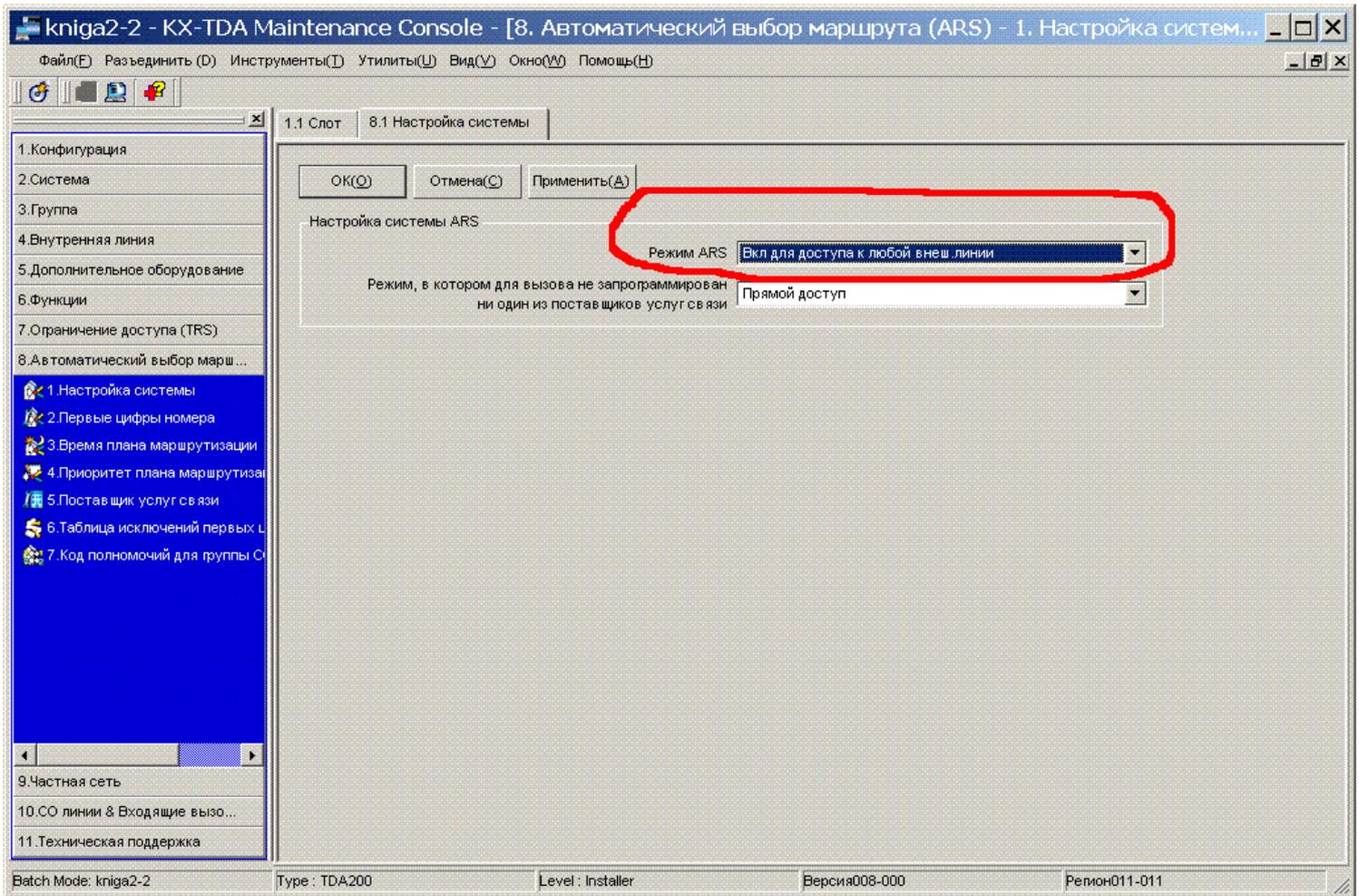
Выбираем ARS mode (Режим ARS) как ON for ANY CO ACCESS (ВКЛ. ДЛЯ ДОСТУПА К ЛЮБОЙ ВНЕШ. ЛИНИИ) (т.е. функция ARS будет работать при любой попытке позвонить по этим линиям, не только при выходе по 9, но и по кодам 804, 805, \*37077 и т.д.)
